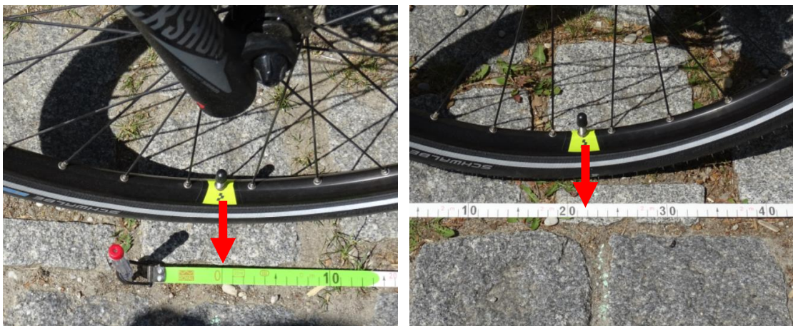
Abb. 1: Messen der Abrolllänge, links am Start und rechts nach einer ganzen Umdrehung
