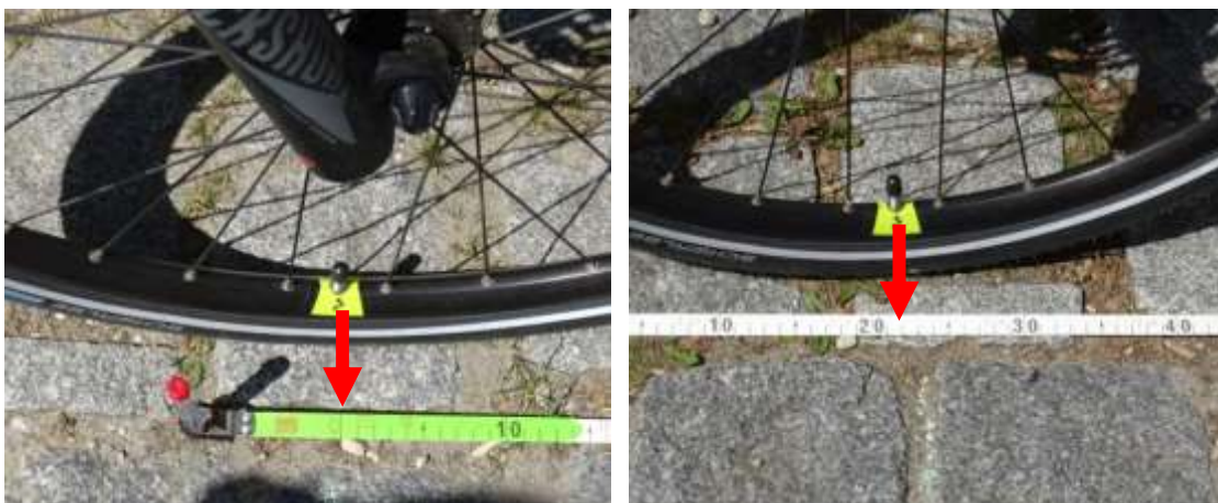
Abb. 2: Messen der Abrolllänge, links am Start und rechts nach einer ganzen Umdrehung
